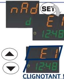
Appuyer sur la touche "set" correspondant au sous-répertoire choisi pour accéder aux paramètres **E0**, **E1**, **E2** et **E3**. Utiliser les touches "UP" et "DOWN" pour faire défiler ces paramètres.
