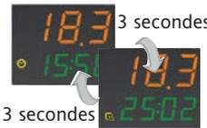
Appuyer de nouveau sur la touche « set » pour visualiser la température maximale mesurée par la sonde durant la mémorisation de l'alarme (sur l'afficheur **A**) avec l'heure/date correspondantes (sur l'afficheur **B**).
