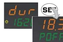
Appuyer de nouveau sur la touche « set » pour visualiser la température maximale mesurée par la sonde entre la température au moment de l'extinction et la température au moment du rallumage de l'instrument en cas de dépassement du seuil de température programmée.
